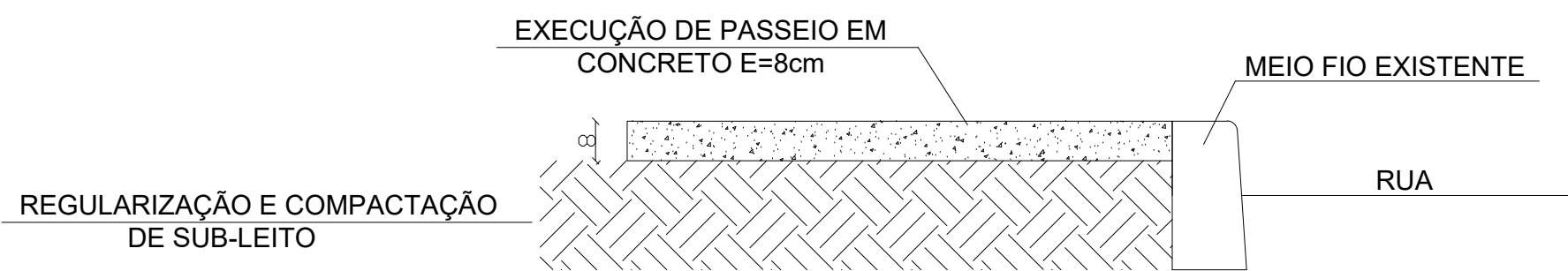
DETALHE EXECUÇÃO DE PASSEIO sem escala
